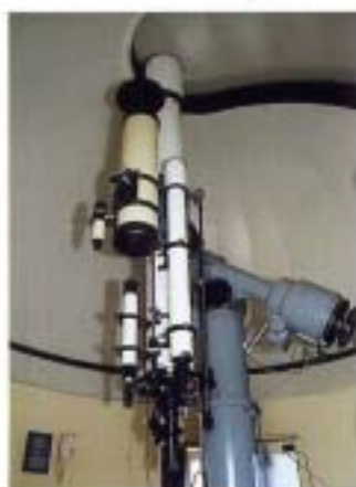
天文台に口径20センチ及び12・5センチの屈折望遠鏡と16センチ反射望遠鏡を配置
